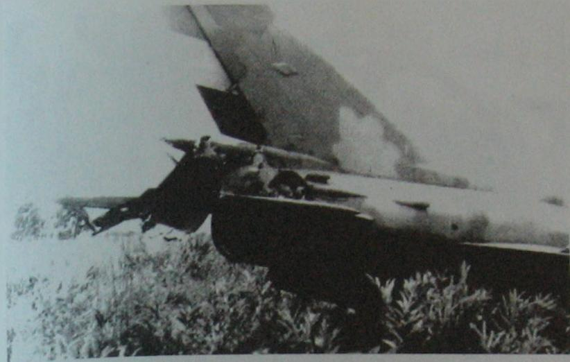
Fig. 7. Daño típico causado por impacto de cohete antiaéreo portátil. En caso como este era posible el regreso a tierra, aunque el aterrizaje era complicado. Este avión venía a posarse con un freno trancado y se despistó.
